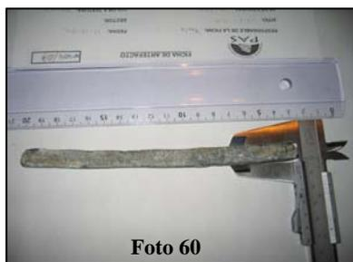
Nº V04/56 Pieza de cobre con oxidaciones de sulfato de cobre y algunos agujeros en uno de sus lados. Dimensiones 12.9 cm x 2.8 cm. Aportado por un coleccionista particular.
