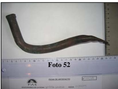
Nº V04/48 Clavo redondo de cobre sumamente doblado, posee signos visibles de corrosión, oxido y sulfatos de cobre. Dimensiones 19.5 cm. Aportado por un coleccionista particular.
