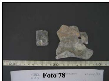
Nº V04/77 Dos láminas de plomo rectangulares (forro). Lámina número 1 – dimensiones 8.2 cm x 9 cm, espesor 0.2 cm.
