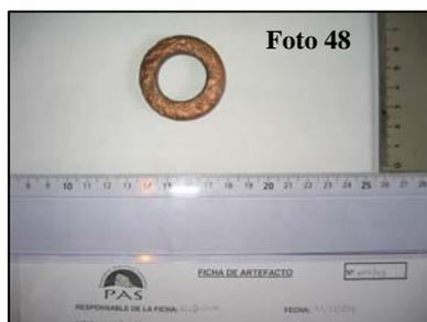
Nº V04/43 Aro metálico de bronce de 0.7 cm de espesor el cual presenta marcas provocadas durante la acción erosiva al intentar limpiarlo. Dimensiones 4.2 cm de diámetro externo y 2.9 cm de diámetro interno. Aportado por un coleccionista particular.
