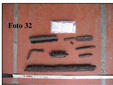
Nº 14 Fragmento de varilla, posee aún gran cantidad de hierro, en su estado actual 1.8 cm de ancho por 3.1 cm de largo por 14 cm de espesor, el espesor original de la pieza sería de 3 cm. Dimensiones 6.9 cm x 2.2 cm espesor 0.4.
