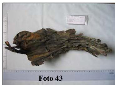
Nº V04/30 Fragmento de lámina de plomo plegada a causa de la degradación física. Asociada a ella observamos seis clavos de cobre, algunos están erosionados, y otros cortados. La superficie esta plegada y sus puntas erosionadas por exposición al salitre. Dimensiones 36.5 cm x 13.4 cm x 5 cm.
