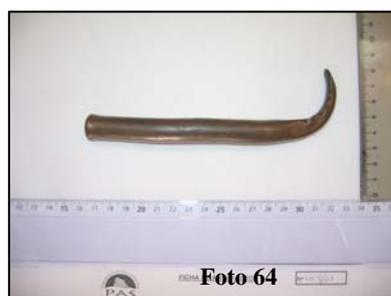
Nº V04/61 Clavo de cobre de sección redonda, curvado en su parte distal. Dimensiones 18.5 cm x 1.4 cm, cabeza 1.9 cm. Aportado por un coleccionista particular.
