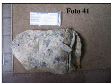
Nº V04/28 Fragmento de lámina de plomo gris, maleables, con bordes y puntas dobladas. En ambas caras se aprecian restos de mejillones. En un extremo de la pieza se observó una perforación adjudicada a un tornillo. Dimensiones 11 cm x 18.3. Aportado por un coleccionista particular.
