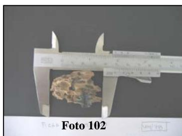
Nº V04/78 Fragmento de madera alterado en toda su superficie por el accionar de teredo, tiene manchas verdes producidas por la corrosión del cobre, presenta improntas oscuras de 0.3 cm x 1.4 cm, se trata de la impronta producida por la degradación de un clavo.
