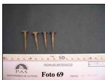
Nº V04/66 Cuatro clavos de cobre sección cuadrada y cabeza frezada. En promedio sus dimensiones son 3.6 cm de largo, cabeza 1.1 cm, y 0.4 cm de espesor. Corroído. Aportado por un coleccionista particular.
