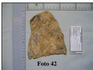
Nº V04/29 Fragmento rígido de lámina de plomo. Superficie con impregnaciones de carbonato de sodio, sílice, y restos de caracololitos. Posee bordes irregulares, sus puntas están dobladas. Dimensiones 12.3 cm x 12,5 cm. Aportado por un coleccionista particular.
