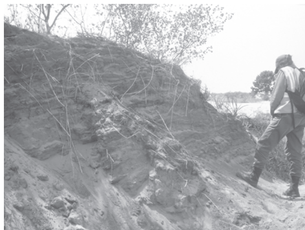
Figura 4. Ejemplo de acopio con estratificación irregular de arenas con cantos sin conchillas.
