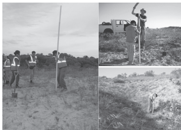
Figura 9. Extracción de testigos sedimentarios ( cores ) en sistemas arenosos de gran potencia.
