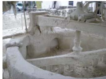
Una vez producida la pasta de cal se pasa de las piletas a un conducto y se le van agregando distintos tipos de arena según el uso que se le quiera dar; por ejemplo, la arena fina se utiliza para revocar. Esta mezcla con la arena se realiza a demanda y al momento de la venta de la pasta.
